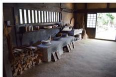
◎三和土…赤土や砂利などに石灰とにがりを混ぜて練り、塗って叩き固めた素材のことで、土間の表面に仕上げ材として使われていた。
