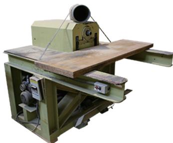
オケクラフトの作り手に限らず、時松辰夫氏から木工ろくろを教わった作り手の多くは、ほぼこの「時松式木工ろくろ」を使用しクラフトを製作しています。
