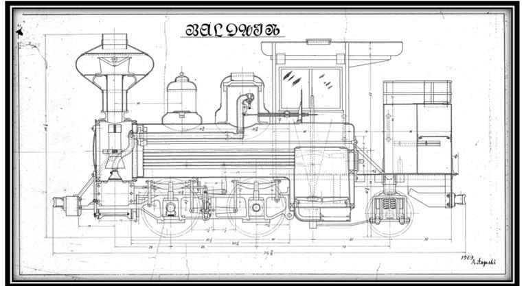
ボールドウィン側面図（縦：59cm 横：83cm）
